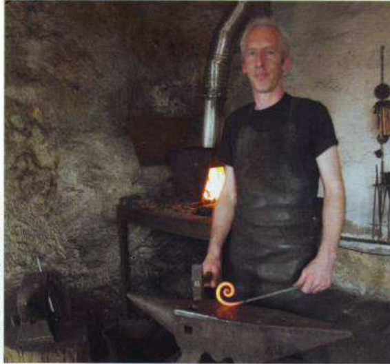
Yvan Mercier dans son atelier forge une volute, élément décoratif par excellence dans la ferronnerie d'art.
